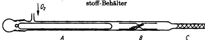
Abbild. 4. Verbrennungsrohr für C-H-Bestimmung aluminiumorganischer Verbindungen. A: Quarzkörper, der die Rückdiffusion von Wasser und Kohlendioxyd verhindern soll.
